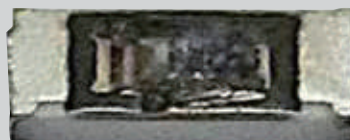
V廠牌抗浪湧貼片電阻 (1206封裝) 100Ω, 5%
